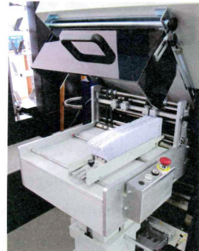
Die Stehendbogensauslage SKM 36 ist ideal für Kleinformate.
