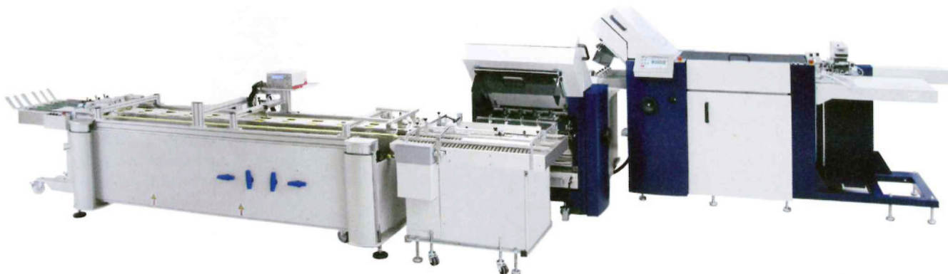
Vakuumband mit Heißleimventil und Pflugfalz, inline integriert nach der Falzmaschine prestige-Fold Net 52.
