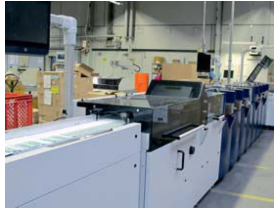
Die AutoSET 18 verfügt bei Drescher am Ausgang über einen Kuvertwendemodul. Das großzügig dimensionierte Lager fasst am Standort Offenburg 1.000 Paletten.
