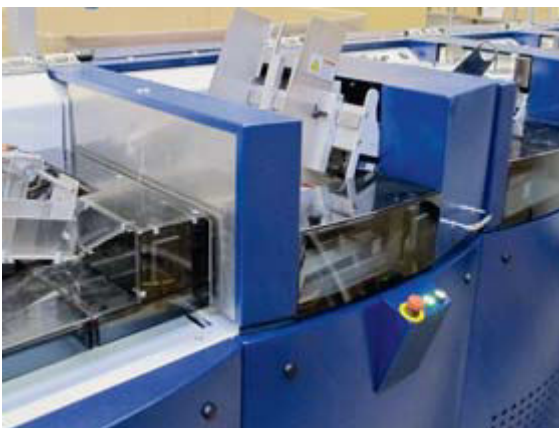
Links: Das Kuvertiersystem kann bei Drescher entweder mit Einzelblattware oder Endlosmaterial von der Rolle beschickt werden.
