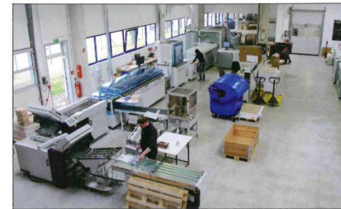
Die neue Produktionslinie ermöglicht die integrierte Fertigung von der Rolle bis zum gefalzten Endprodukt auch für niedrigere Auflagen.
