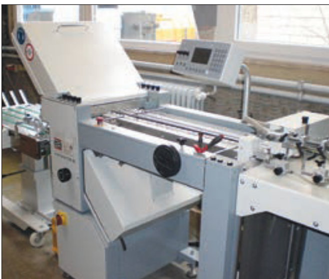
Auf zwei automatisierten Falzmaschinen der Baureihe multi-master CAS 38 werden normale Falzaufgaben sowie die Herstellung von Selfmailern erledigt.
