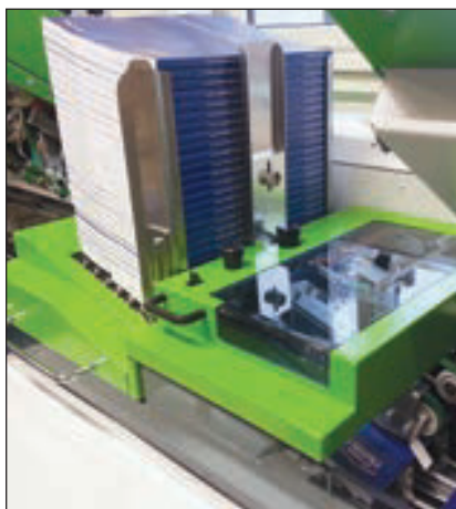
Mit dem Kataloganleger können auch Beilagen mit einer Produktdicke von bis zu 15 mm problemlos verarbeitet werden.
