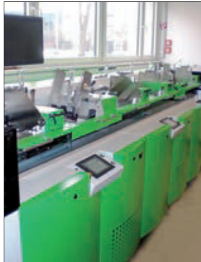
Das bereits vorhandene Kuvertiersystem autoSET B4 verfügt über sechs Beilagenstationen mit unterschiedlichen Beilagenanlegern zur Verarbeitung eines breiten Materialspektrums.
