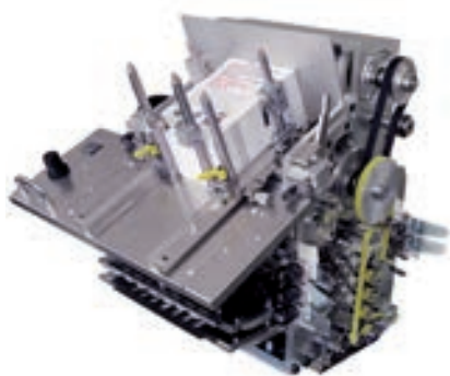
Der neue manuelle leafletFOLDER 21 kombiniert innovative Technologie mit einem Maximum an Effizienz. Das Falzmodul ist konzipiert für die Integration in Kartonier- und Verpackungsmaschinen.
