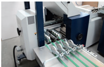
Das Schwertfalzwerk MS 45 ist mobil und höhenverstellbar.
